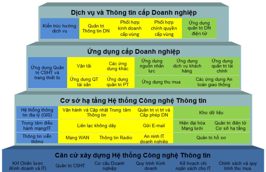
Hình 3. Sơ đồ cấu trúc hệ thống thông tin hình tháp phục vụ VTHKCC
